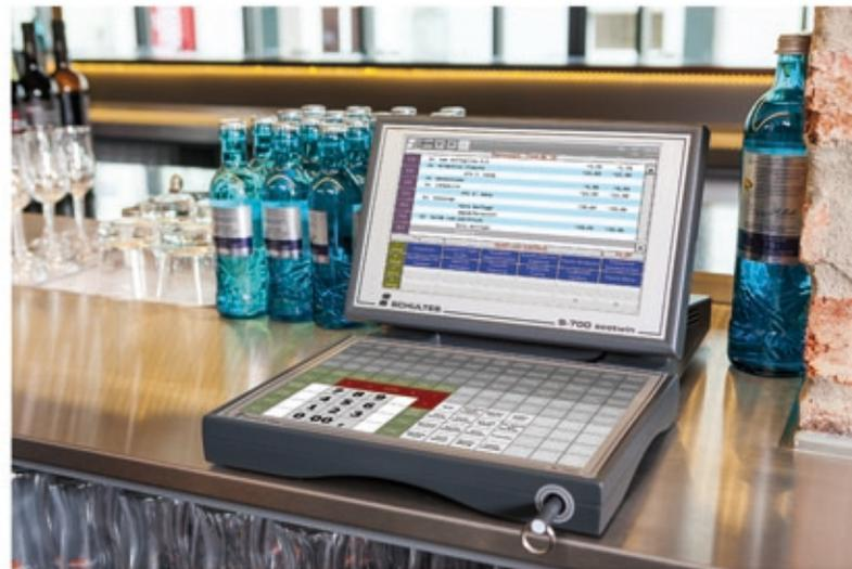
Der brillante 26 cm / 10,1" Farb-Touchscreen ist mit dem Gehäuse versiegelt eingebaut und lässt so weder Schmutz noch Spritzwasser durch.
